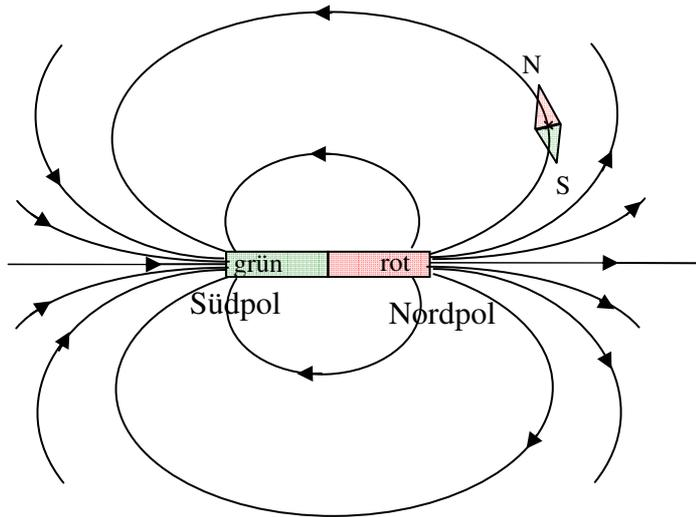
Die Enden des Stabmagneten nennt man Nord- bzw. Südpol.
