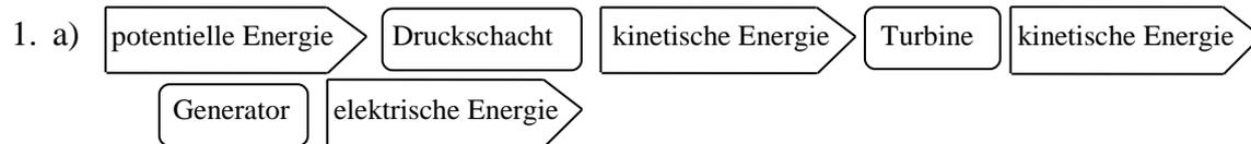
Durch Reibung verliert man Energie (durch Erwärmung Umwandlung in innere Energie); ein Teil der Energie steckt auch noch als kinetische Energie im Wasser, denn nach der Turbine besitzt das Wasser immer noch etwas Geschwindigkeit.
