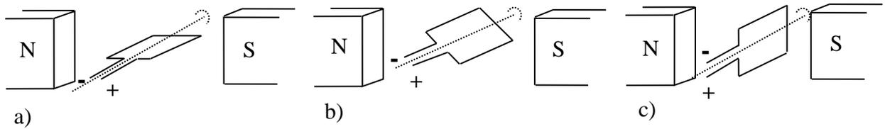
Was passiert, wenn man die Drahtenden der Leiterschleife mit dem so genannten Polwender (auch Kommutator genannt) verbindet und der elektrische Strom über zwei Schleifkontakte zugeführt wird?
