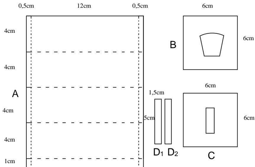
Falte Teil A zu einer quadratischen Röhre und verklebe mit Tesafilm. (Dunkle Flächen innen!) Schneide aus Teil B bzw. C die Öffnungen für das CD-Gitter bzw. den Spalt.
