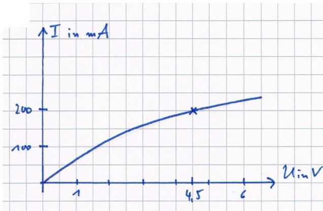
c) Die Kennlinie der Glühlampe ist keine Ursprungsgerade, wie das bei einem ohmschen Widerstand der Fall ist.
