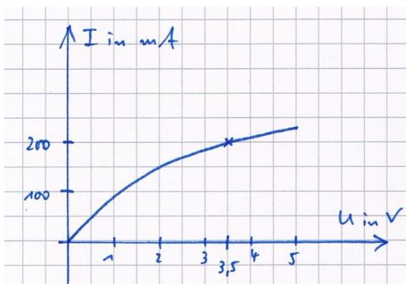
c) Die Kennlinie der Glühlampe ist keine Ursprungsgerade, wie das bei einem ohmschen Widerstand der Fall ist.
