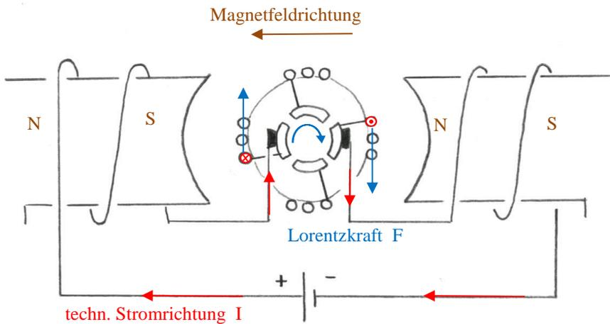
Der Anker rotiert im Uhrzeigersinn.
