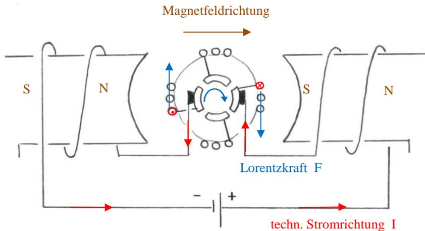
Der Anker rotiert im Uhrzeigersinn.
